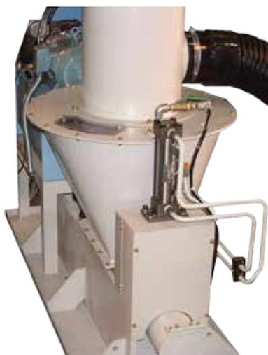
アルミ切断機用に開発された切粉圧縮機です。アルミ切粉を 1/30 に圧縮することが可能です。
