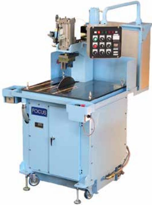
バンドパイプ専用の丸鋸切断機です。鋸刃はテーブル内に収納されているため、テーブルが自由に使えます。
