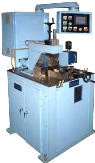
ハイスメタルソーと超硬チップソーの両方が使える半自動丸鋸切断機です。鋸刃は下から上昇するためパイプ切断に最適です。
